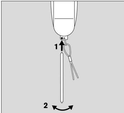
Attention, lors de l'ouverture de tube Dräger des éclats de verre peuvent être projetés! Maintenir la pompe avec la boucle de maintien vers le bas, sinon les éclats risquent de pénétrer dans la pompe!
