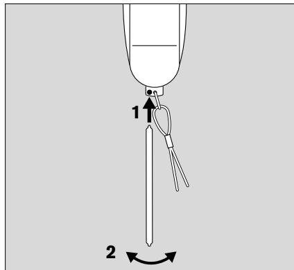
**Vorsicht beim Öffnen des Dräger Röhrchens, es können Glassplitter abspringen! Pumpe mit der Schlaufe nach unten halten, sonst können Glassplitter in die Pumpe gelangen!**
